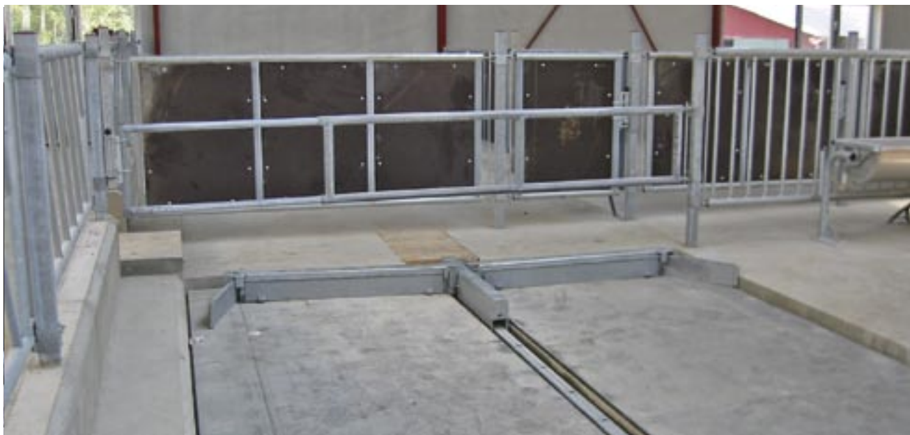
Hydraulisk stegmatare för öppna skrapgångar eller spalt. Patenterad framdrivning.
