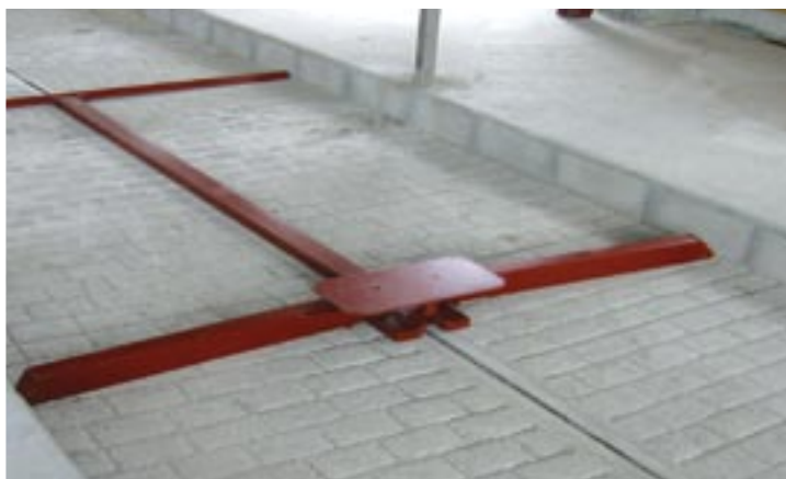
T-skrapa med trampskydd för öppna skrapgångar.
