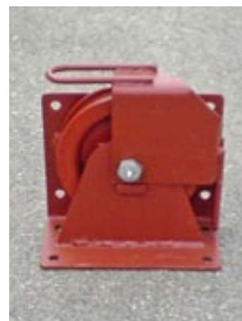
Kombiblock med flera monteringsmöjligheter.
